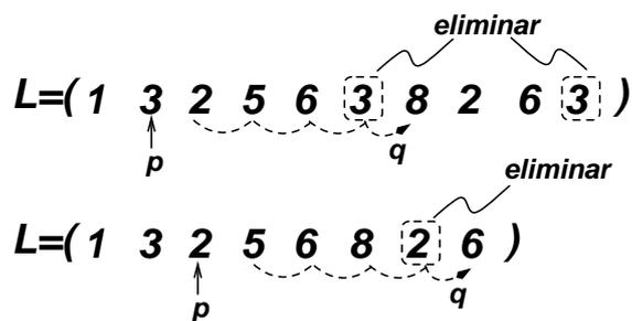
Figura 2.1: Proceso de eliminación de elementos en purge
